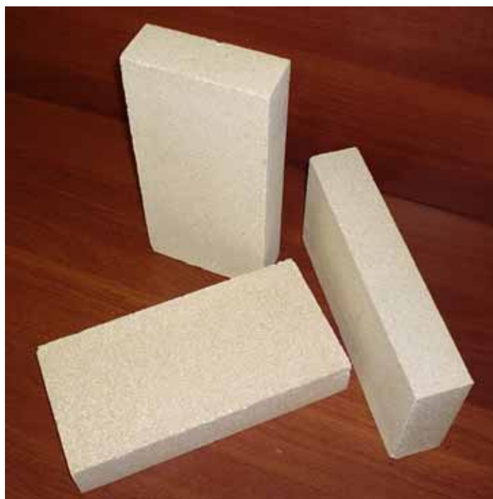
Рис. 2. Интегрированные высокотемпературные теплоизоляционные материалы – внешний вид изделий.
